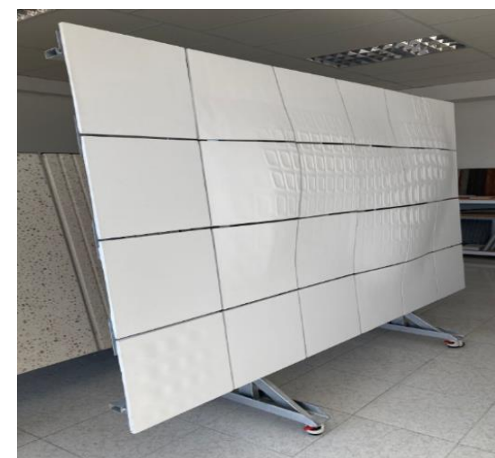
Mock up con paneles de GRC
